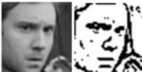
Figura 4.8 Aplicarea filtrului prag adaptiv gaussian ( Adaptive Thresh Gaussian ) pe fotografie
