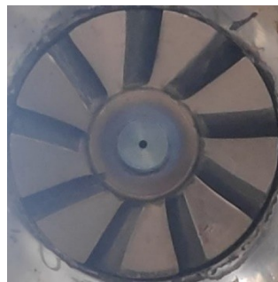
Figura 2.9- Turbionatorul cu orificiul central de 2 mm în diametru pentru injecția de combustibil în incinta de ardere.
