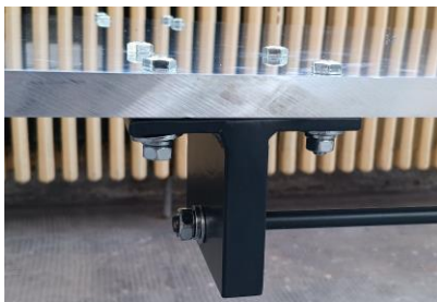
Fig. 8.11. Sistemul de prindere al barei anti-încovoiere [36].
