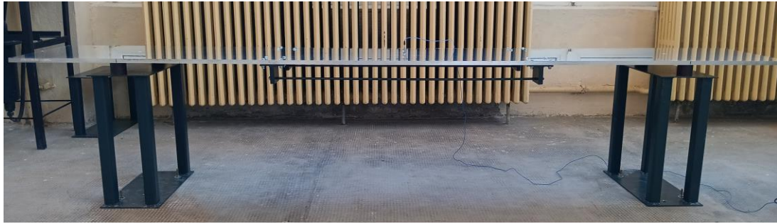
Fig. 8.9. Modelul experimental al cutiei cu bare anti-încovoiere [36].
