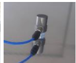
Fig. 8.18. Montarea accelerometrului pe modelul experimental al cutiei.
