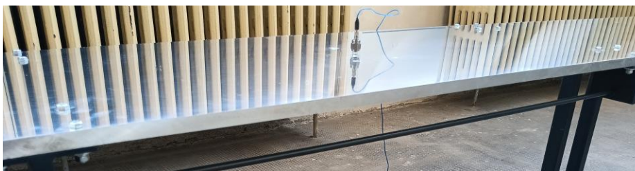
Fig. 8.18. Montarea accelerometrului pe modelul experimental al cutiei.
