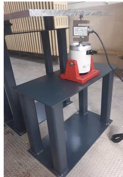
Detaliu – amplasarea ansamblului vibrator – celula de forță.
