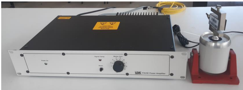
Fig. 8.16. Ansamblul vibrator – amplificator – celula de forță.
