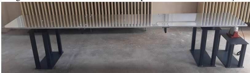
Fig. 8.17. Amplasarea ansamblului vibrator – celula de forță.
