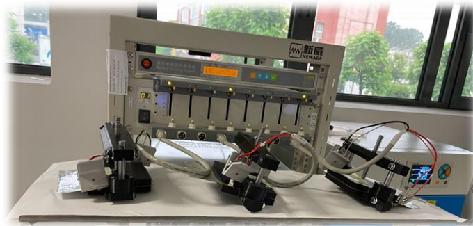
Fig. 18. Testarea celulelor de tip pouch, pe sistemul de testare
