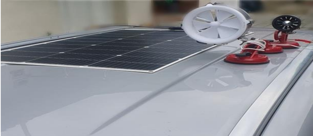
Figura 4.25 Sistemul hibrid montat pe mașină
