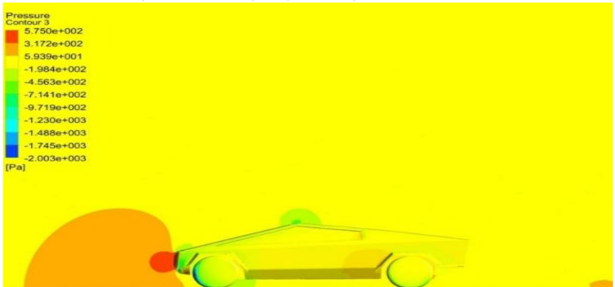
Figura 4.1 Simulare digitală pentru analiza presiunii
