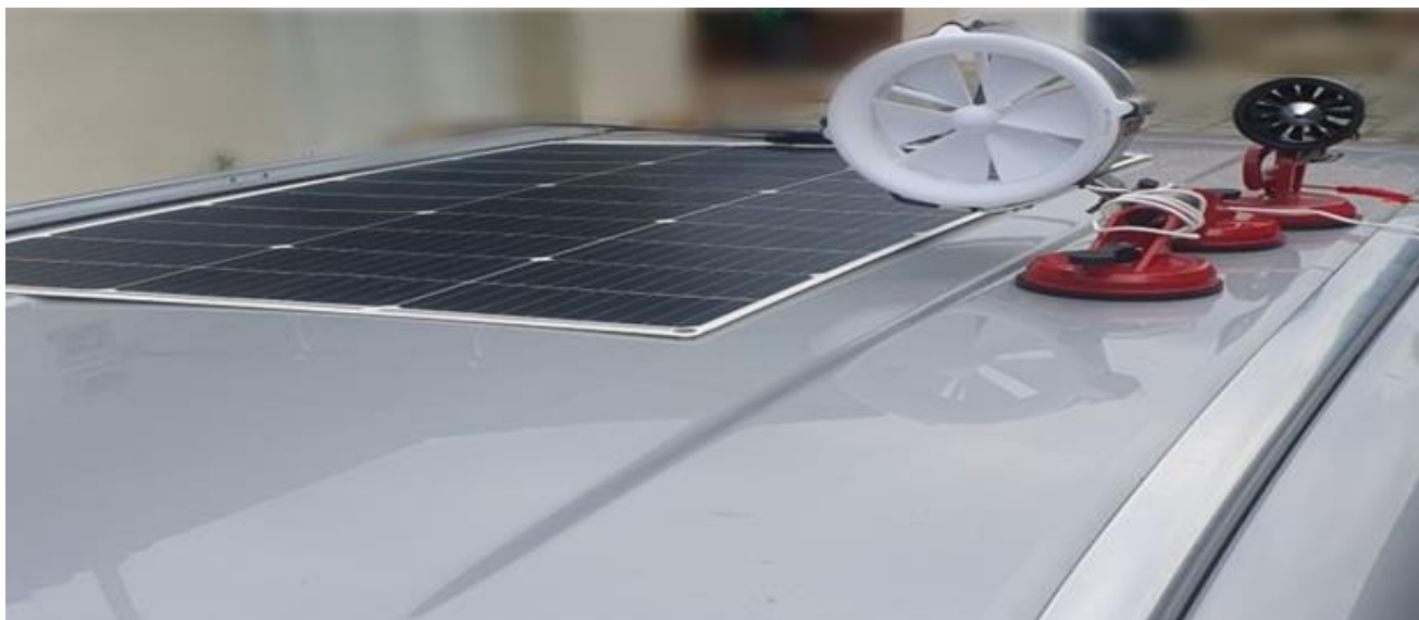
Figura 4.25 Sistemul hibrid montat pe mașină
