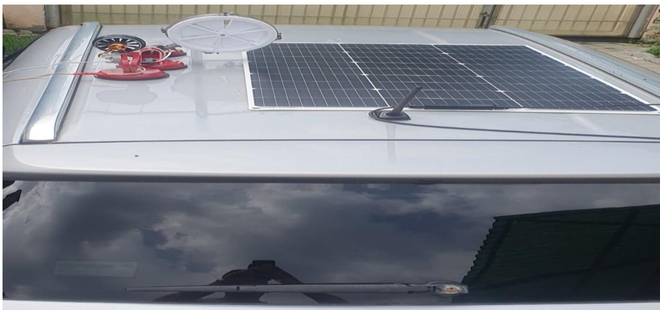
Figura 4.26 Sistemul hibrid montat pe mașină, vedere din spate
