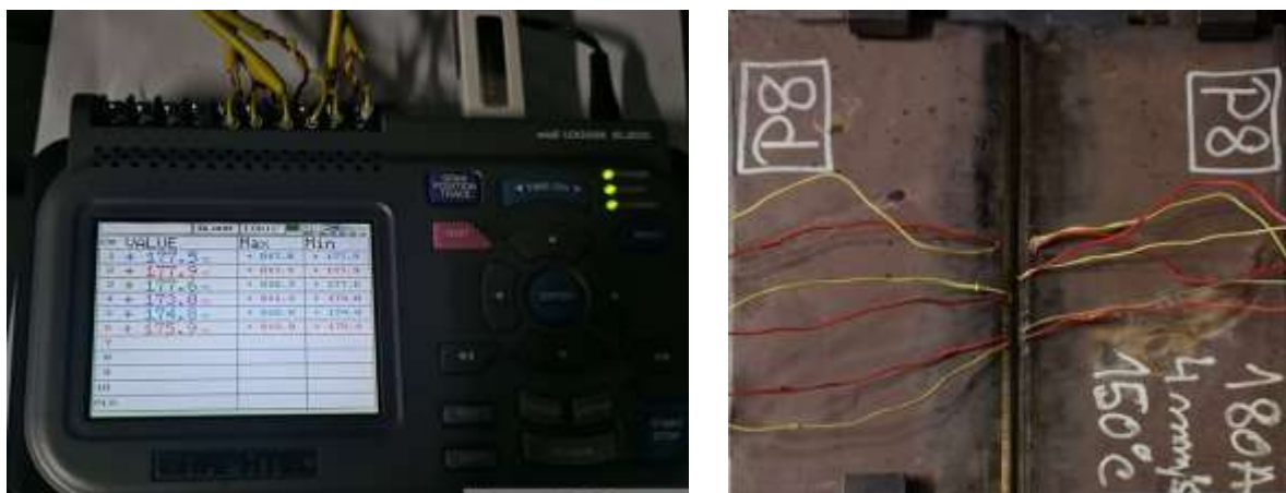
Fig. 5.2. Măsurarea valorilor temperaturilor în zonele îmbinărilor sudate
