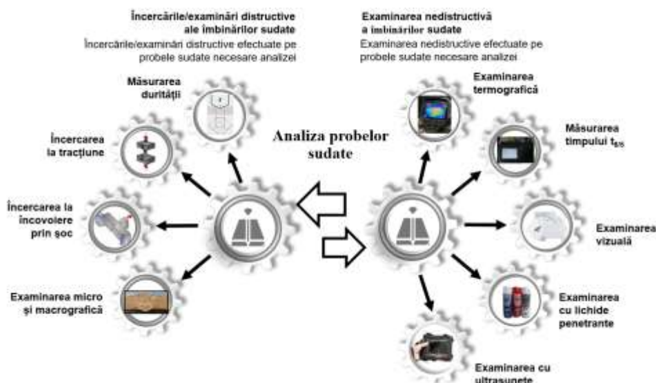
Fig. 5.1. Analiza rezultatelor îmbinărilor sudate realizate pe materialul S890QL
