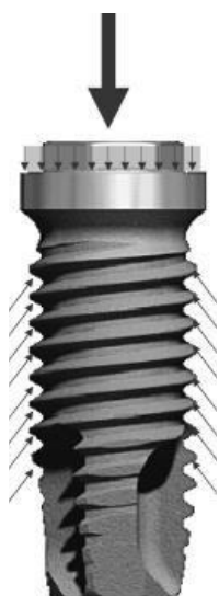
Figura 1.12. Distribuția încărcăturii axiale. Morfologia filetelor poate influența natura forței compresive create în osul din jurul unui implant prelucrat [6]
