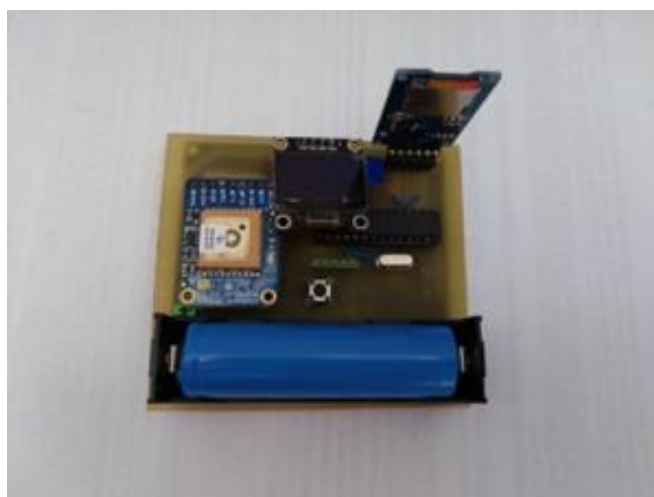
Figura 4.3 Modulul electronic în varianta finală- vedere din plan superior
