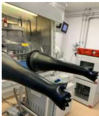
Fig. 6. 1 Echipamentul Glove-Box în interiorul căruia s-au asamblat în siguranță celulele
