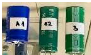
Fig. 3. 6 Cele 3 supercondensatoare comerciale de la 3 producători diferiți disponibile de 100F și 2.7V: A1 , E2 , code 3.
