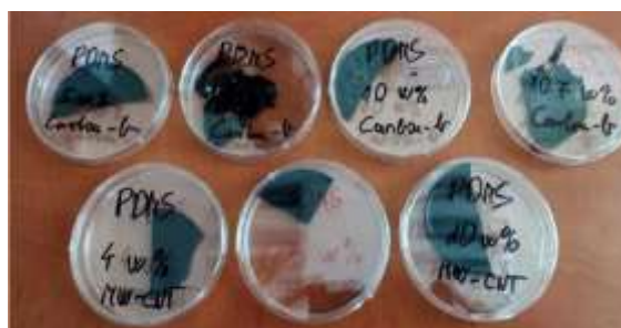
Fig. 4. 1 Probele de nanocompozit PDMS-MWCNTs realizate cu diferite cantități de MWCNTs (4% wt, 7% wt și 10% wt) și Carbon black (5% wt, 7% wt, 10% wt și 10,7% wt).
