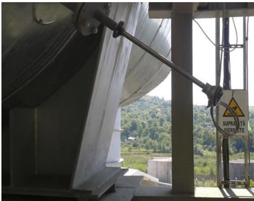
Figura 5.23. Locația de instalare a sondei cu senzor pe bază de SiC în cadrul fabricii de ciment
