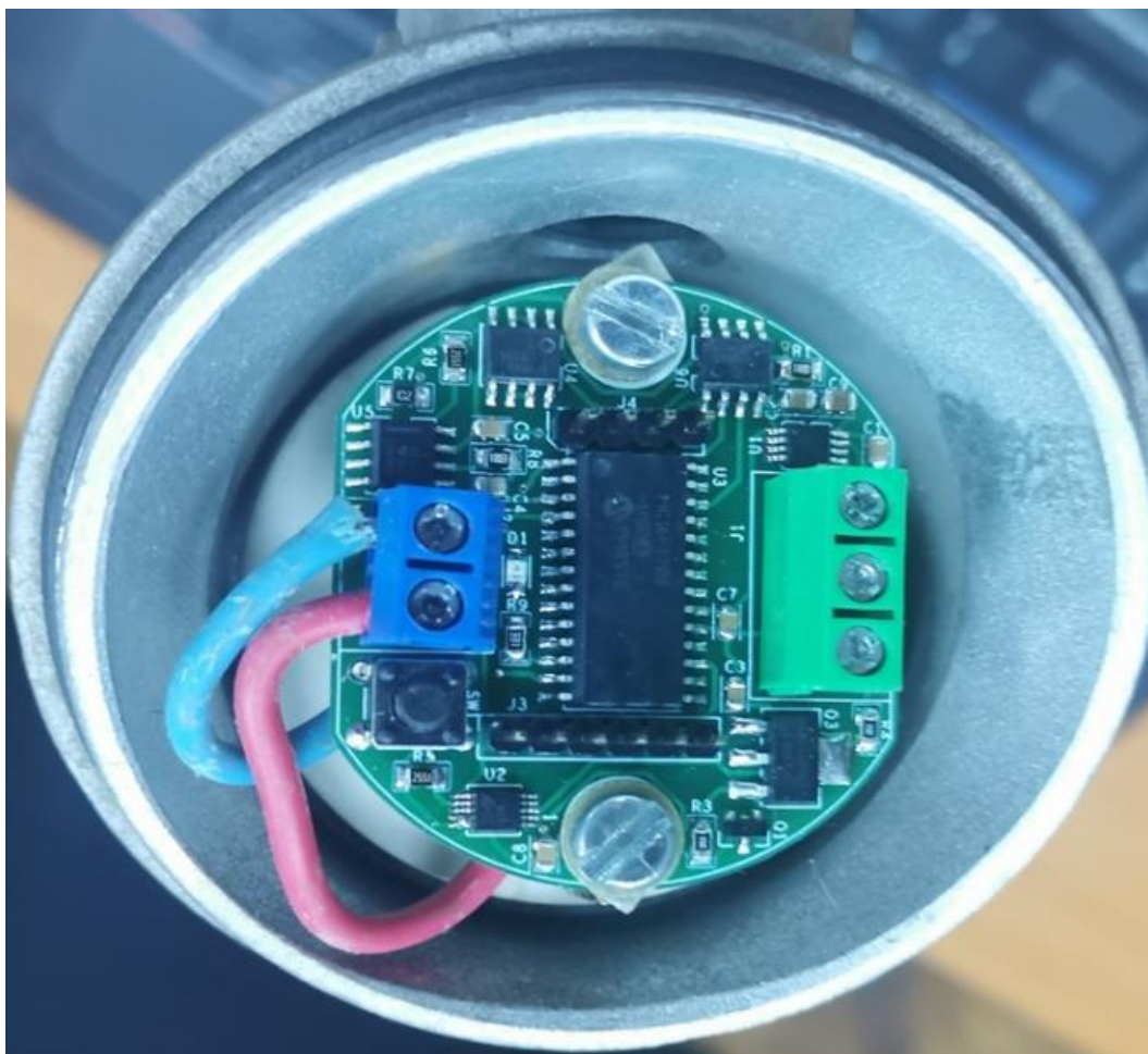
Figura 5.15. Amplasarea circuitului in teaca unei sonde de temperatură utilizată în fabrica de ciment
