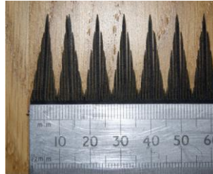
(d) serații triunghiulare cu șanturi („slots”)[6]
