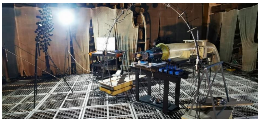
Figura 19. Schema instalatiei experimentale de testare a sectoarelor paletate
