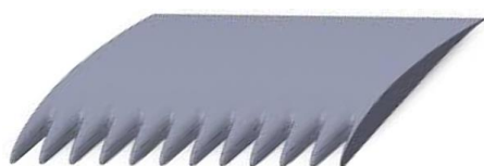
(a) paleta cu bord de atac modificat [6]
