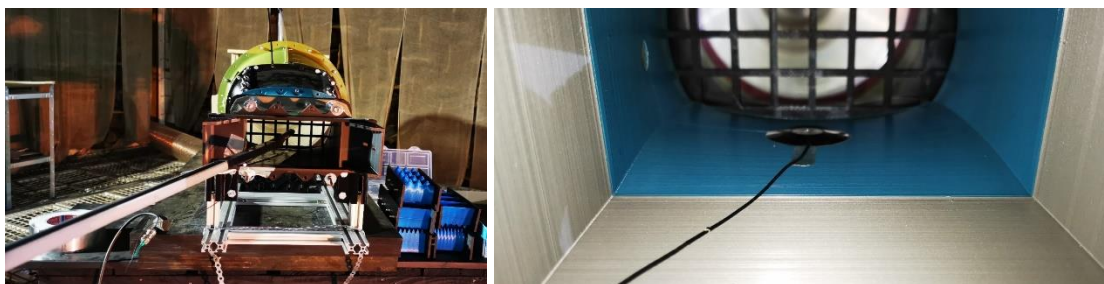
Figura 21. Plasarea microfoanelor pentru identificarea parametrilor turbulenței (stanga- microfon profilat aerodinamic, dreapta- microfon de suprafață)
