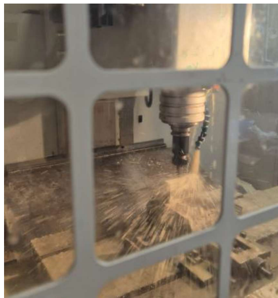
Fig. 7 Frezare CNC bloc aluminiu
